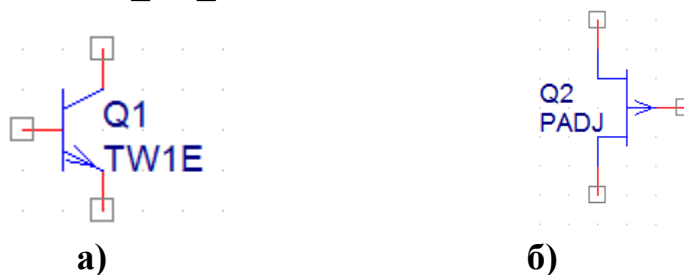
Рис. 2 Графическое изображение моделей транзисторов АБМК_1.4_rad с n-p-n (а) и полевым (б) транзисторами
