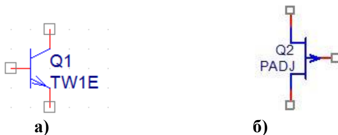
Рис. 2 Графическое изображение n-p-n транзисторов АБМК_1.4_rad с (а) и полевых транзисторов (б)
