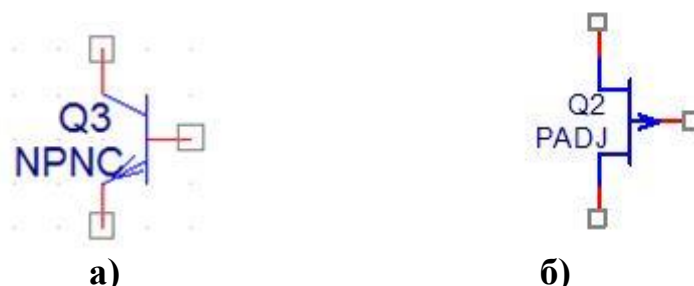
Рис. 2 Графическое изображение n-p-n транзисторов АБМК_1.3_rad с (а) и полевых транзисторов (б)
