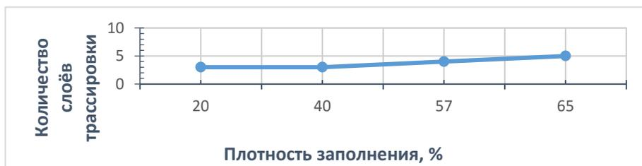
Рисунок 10 – График зависимости количества необходимых трассировочных слоёв от плотности заполнения матрицы БМК
