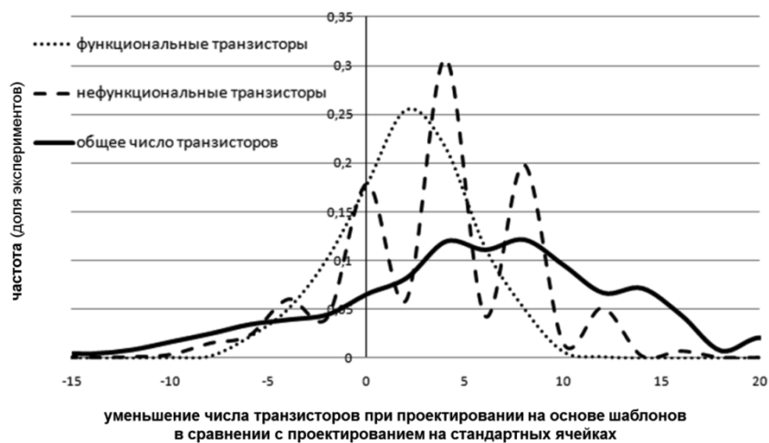
Рис. 11. Гистограмма, показывающая уменьшение числа транзисторов при синтезе на основе шаблонов и на стандартных ячейках
